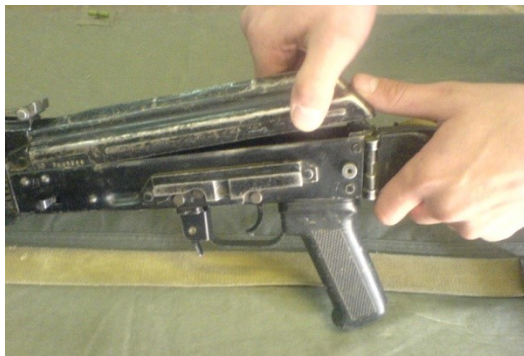
Рисунок 4 – Отделение крышки ствольной коробки
