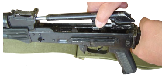
Рисунок 6 – Отделение затворной рамы с затвором
