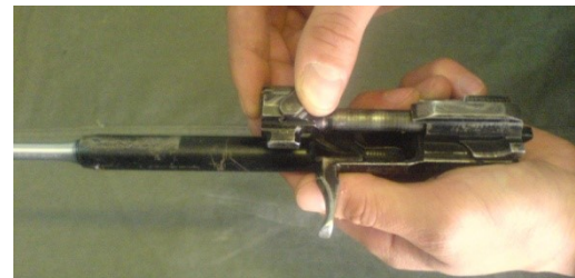
Рисунок 7 – Отделение затвора от затворной рамы
