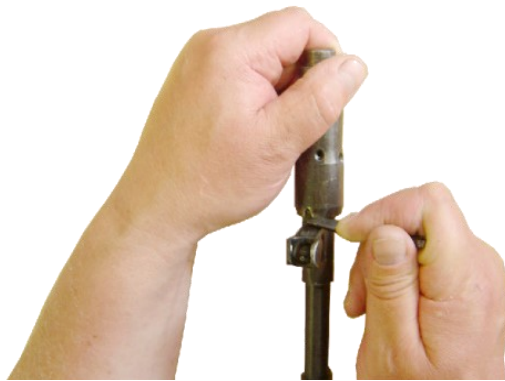
Рисунок 3 – Отделение дульного тормоза-компенсатора
