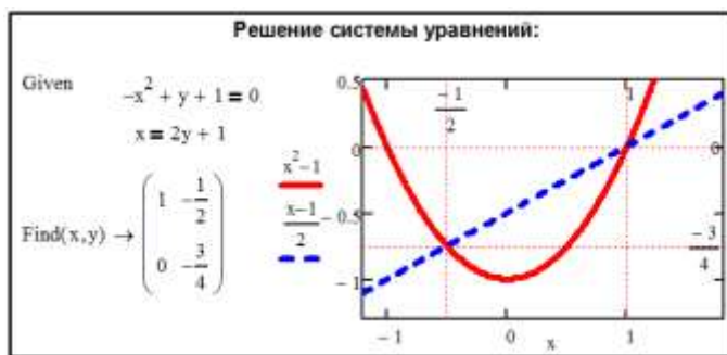
Рисунок 2 – Алгоритм решения системы двух нелинейных уравнений в среде интегрированного математического пакета Mathcad
